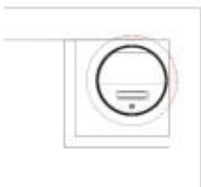
**Achtung!** Wird das Fallrohr direkt in einer Raumecke platziert und Sie planen einen Einwurf von oben, dann kann zumeist nur eine Türe mit schmalen Rahmen verwendet werden (340x340mm) da ansonsten der Türrahmen mit der Wand kollidieren würde.
